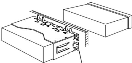
С помощью отвёртки или подобного инструмента отогните выступы монтажной коробки и установите её на место.
