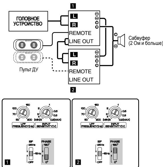
Система Dual Mono Drive представляет собой систему, в которой 2 монофонических усилителя подключены по мостовой схеме для управления одним сабвуфером с высокомощным выходом.
