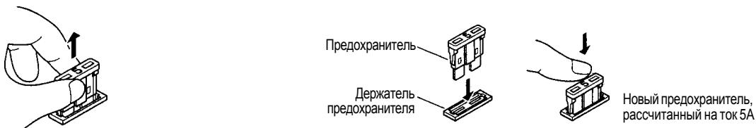
**Предостережение:** Устанавливайте предохранитель, рассчитанный на ток 5 А.
