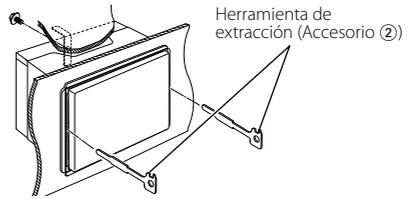
4. Mueva la herramienta de extracción hacia abajo, y extraiga la unidad hasta la mitad mientras presiona hacia adentro.
