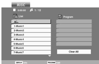
Presione las teclas del cursor hacia arriba/abajo [▲/▼] para seleccionar una pista, y presione luego la tecla [▶] o [ENTER] y se iniciará la reproducción.
