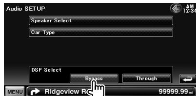
**[Bypass]** Le système DSP ne produit pas d'effet.
