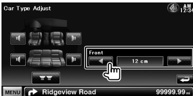
Faça um ajuste fino do tempo de atraso da saída de altifalante especificada em <Configurar o tipo de automóvel> para proporcionar um ambiente mais adequado para o veículo. As definições do tempo de atraso são identificadas automaticamente e compensadas especificando as distâncias de cada altifalante do centro do interior do veículo.
