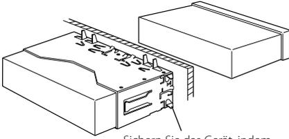
Sichern Sie das Gerät, indem Sie die Metalllaschen mit einem Schraubendreher o. Ä. umbiegen.
