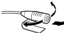
Ajustez l'orientation du microphone vers le chauffeur.
