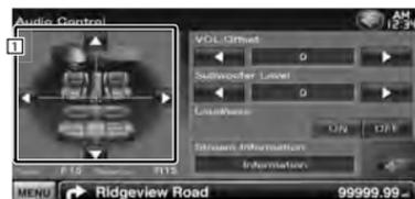
1 Ajusta el balance delantero/trasero e izquierdo/derecho del volumen al tocar la pantalla de ajuste.
