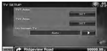
**[TV1 Area], [TV2 Area]** Configura el área de recepción de TV. (solo con KTC-V300E o KTC-V301E (accesorio opcional) conectado)
