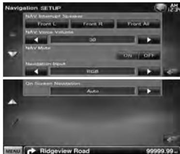
**[NAV Interrupt Speaker]** Selecciona los altavoces utilizados para guía mediante voz del sistema de navegación. (☑ "Front All")
