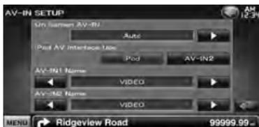
**[On Screen AV-IN]** Configura una visualización en pantalla de la pantalla de reproducción AV-IN. (☑) "Auto")
