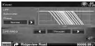
**[Phase]** Ajusta la fase de la salida del subwoofer. La fase se revierte 180 grados al ajustar "Reverse".
