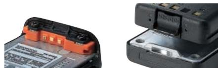
Se ha adoptado una nueva estructura de extracción de la batería colocando piezas móviles en la batería para una mayor fiabilidad.
