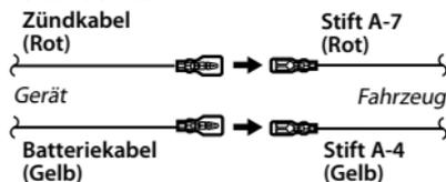
[2] Der Stift A-7 (Rot) des ISO-Anschlusses am Fahrzeug ist mit der Konstantspannungsquelle verbunden, während der Stift A-4 (Gelb) mit der Zündung verbunden ist.
