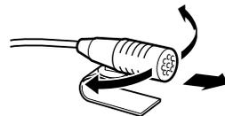
Ajustez l'orientation du microphone vers le chauffeur.
