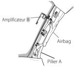
Le cache du pilier A est sécurisé à l'aide d'une attache spéciale qu'il faudra peut être remplacer lorsque le cache du pilier A est démonté.
