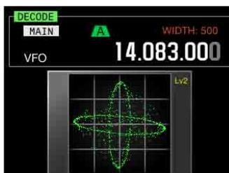
Osciloscopio de X-Y
