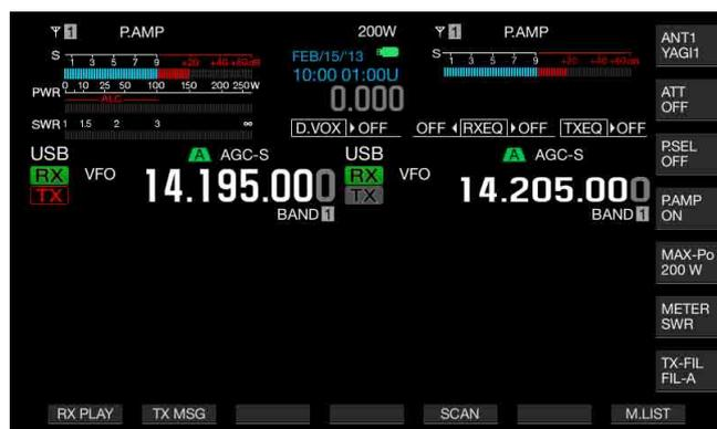
El medidor S para la banda secundaria aparece en la parte superior derecha de la visualización principal.
