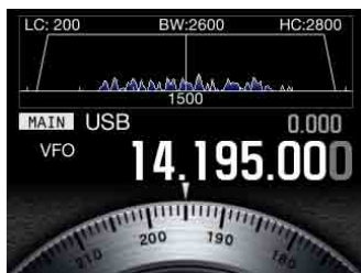
Frecuencia de la banda seleccionada Visualización del osciloscopio de la banda de audio y Dial
