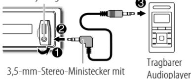
3,5-mm-Stereo-Ministecker mit "L"-förmigem Anschluss (im Handel erhältlich)
