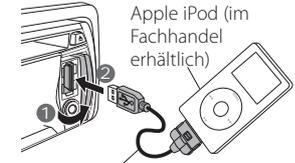
Zum Anschließen eines iPods ist Stecker KCA-iP102 (optionales Zubehör) erforderlich.
