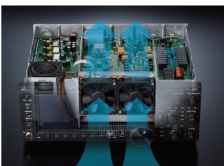
Die beiden Ventilatoren liegen hinter der Frontplatte
