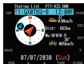
Anzeige der eigenen Station im Verhältnis zu anderen: Position der eigenen Station sowie die relative Entfernung, Richtung, Kurs und Geschwindigkeit anderer Stationen
