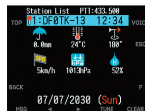
Wetterstationsdaten inklusive Niederschlag, Temperatur, Windrichtung, Windgeschwindigkeit, Luftdruck und Luftfeuchtigkeit
