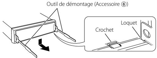
2. Quand la partie inférieure est retirée, retirez les deux crochets supérieurs.
