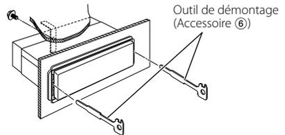
4. Baissez les outils de démontage vers le bas et tirez l'appareil à moitié en faisant pression vers l'intérieur.
