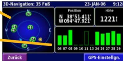
In der Himmelsansicht werden die Satelliten angezeigt, von denen das Gerät Signale empfängt. Die Balkenanzeige für die Satellitensignalstärke zeigt an, wie stark das Signal der jeweiligen Satelliten ist. Ein ausgefüllter Balken zeigt an, dass der GPS-Satellit einsatzbereit ist.
