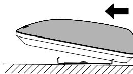
3. Die beiden Vorderseitenvorsprünge des Rahmens ② durch Ziehen des Lautsprechers ① nach vorne in die beiden Vorderseitenlöcher des Lautsprechers einsetzen.
