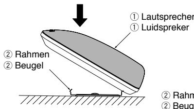
2. Die beiden Rückseitenvorsprünge des Rahmens ② in die beiden Rückseitenlöcher des Lautsprechers einsetzen.
