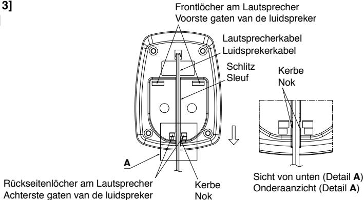
1. Beim Herausführen des Lautsprechkabels aus der Rückseite das Kabel am Schlitz an der Unterseite des Lautsprechers ① entlang schieben und durch Anhaken des Kabels zwischen den Kerben befestigen.
