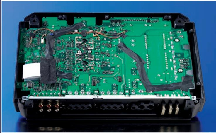
Platz ist in der kleinsten Hütte: Die Platine der PS4D ist sehr kompakt aufgebaut und beherbergt jede Menge Technik auf engstem Raum.
