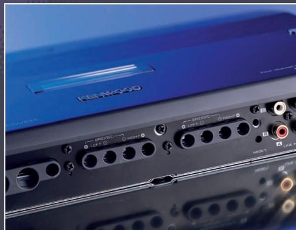
**Sauber: Die Anschlussterminals für Strom und Boxenkabel sind stabil und lassen sich von oben auf- und zudrehen. Neben den Cinch-Eingängen gibt's einen Line-Ausgang für weitere Endstufen.**
