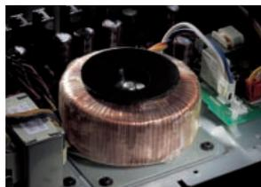
unerwünschte Streufelder und mechanische Schwingungen. Netzteile mit Ringkerntrafos arbeiten sehr effizient und sichern so eine laststabile Stromversorgung.
